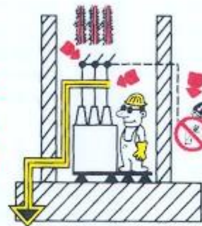
4. Poner a tierra y en cortocircuito.
